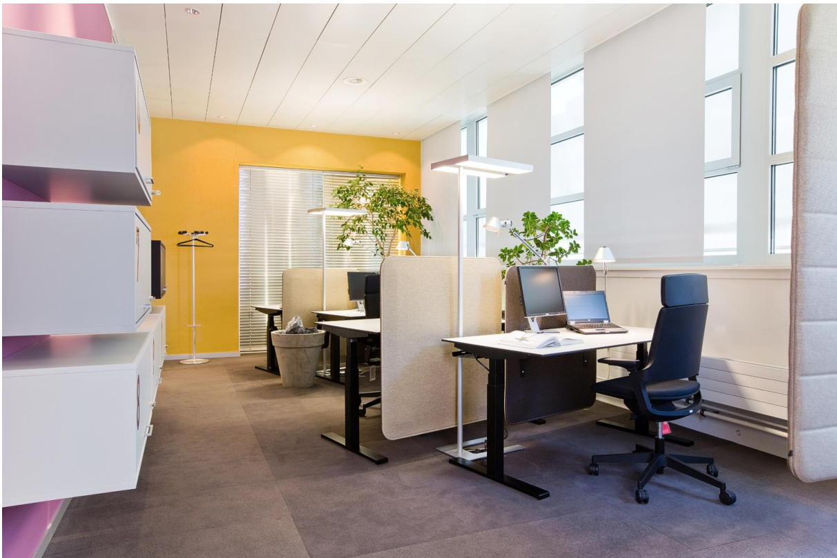
Figure 37: lumière et éclairage diversifiés: l'utilisateur peut régler diverses composantes (éclairage au plafond, lampadaire, lampe de travail, lumière du jour et protection contre l'éblouissement) et donc la luminosité de son poste (facteur d'influence B13)
