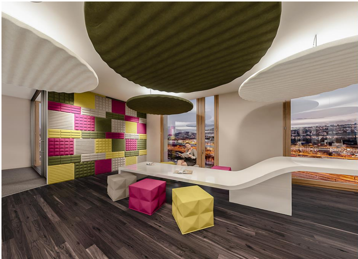
Figure 51: une conception qui tire profit de différents matériaux et de différentes couleurs tout en contribuant à une bonne acoustique (facteurs d'influence B2, B3, B7, B8, B10)
