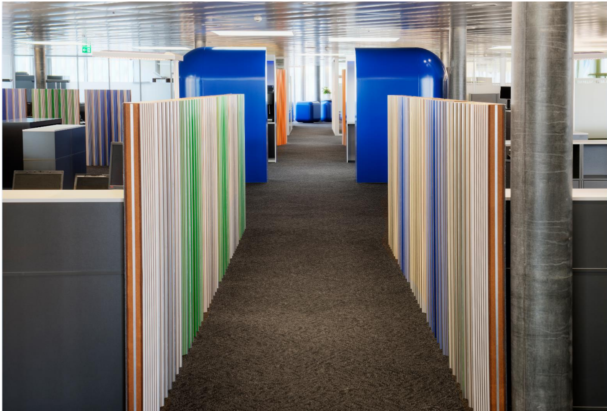
Figure 31: distribution et régulation de la sphère privée: isolement par une installation acoustique à mi-hauteur entre les postes de travail et les voies d'accès (facteurs d'influence B4, B10, B14, B17 et B18)
